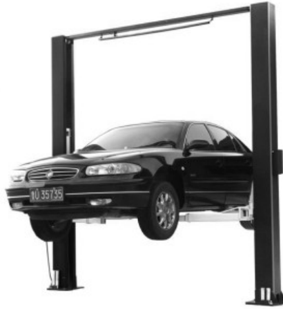
Figura 8.15. Vinçi elektromekanik me dy shtylla për automjete të udhëtarëve
